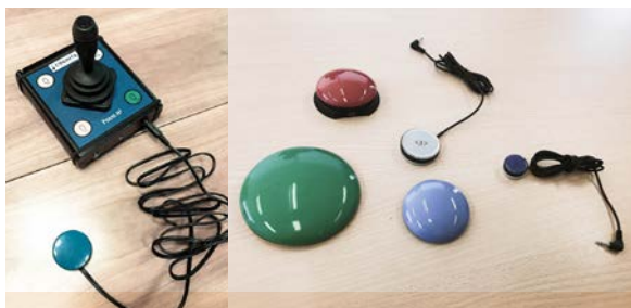
Mange eksterne brytere bruker kabel og mini-jack for å kunne kobles til datamaskin eller joystick, men det finnes trådløse varianter også.
